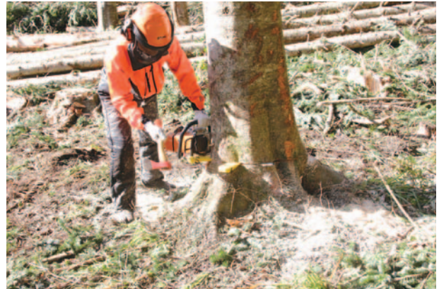
②反対側から追い口を水平に切っていく、くさびを打ちます
